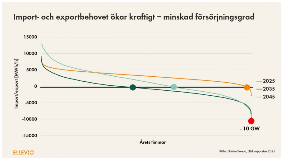
Figur 18 - Överföringsbehov till/från Gävleborgs län för olika årtal baserat på scenarion för utveckling och omställning. Antalet timmar med självförsörjning inom länet krymper från ca 90% 2025 till ca 55% 2035 och ca. 40% 2045.
